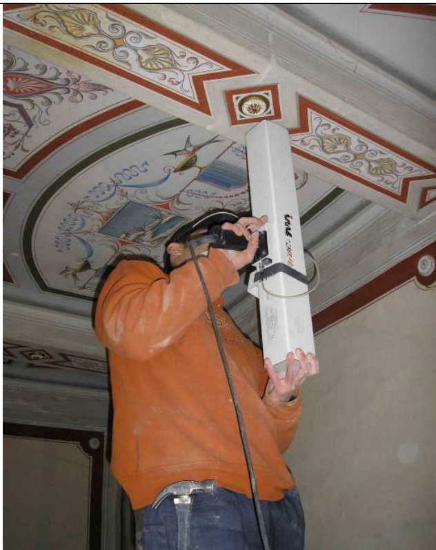
Ispezione strumentale da sotto. La struttura al di sotto del rivestimento non è visibile ma le travi principali sono riconoscibili. Allo scopo di attraversare gli strati di rivestimento vengono eseguiti fori preliminari con un normale trapano. Se correttamente eseguita la prova si può considerare sostanzialmente non distruttiva (anche nei riguardi del rivestimento).
