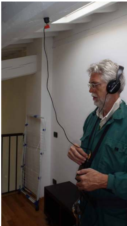
Diagnosi e monitoraggio attacchi in corso da insetti xilofagi
